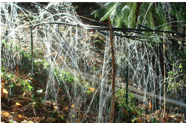
Fig. 15: Dispositif de simulation de pluie
